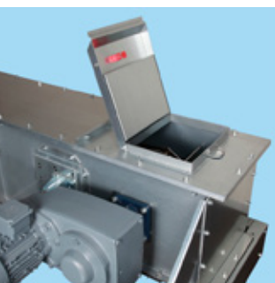
Датчик подпора/смотровая крышка с аварийным выключателем.
